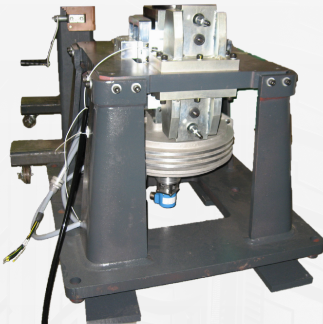
维修后的动平衡装置
