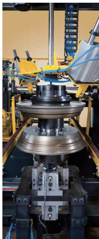
带测量装置的主轴和传送带是系统的核心部件
