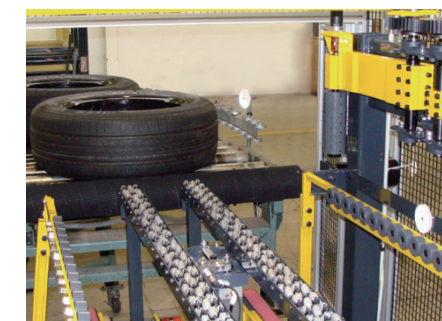
AkroDYNE® 润滑工位（带胎圈润滑装置和轮胎定中）
