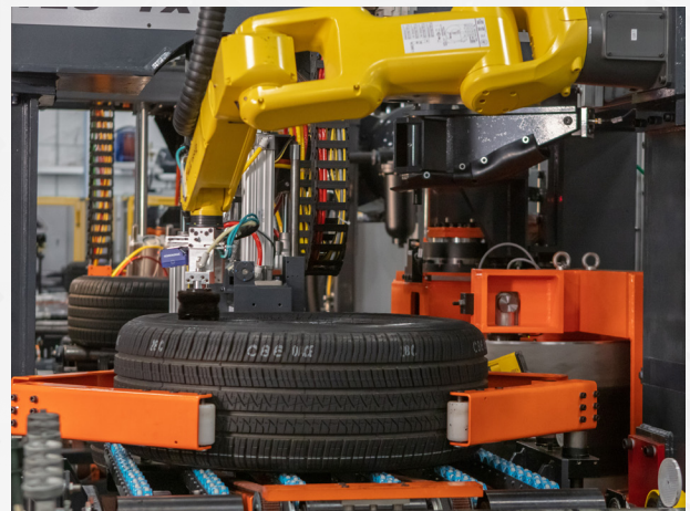
采用机械臂润滑的 ITMS 润滑工位
